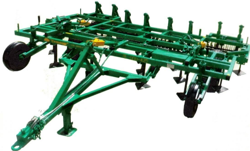
Рисунок 1.11 – Орудие ОПО 4,25 для мелкой безотвальной обработки почвы к трактору тягового класса 30...40 кН
