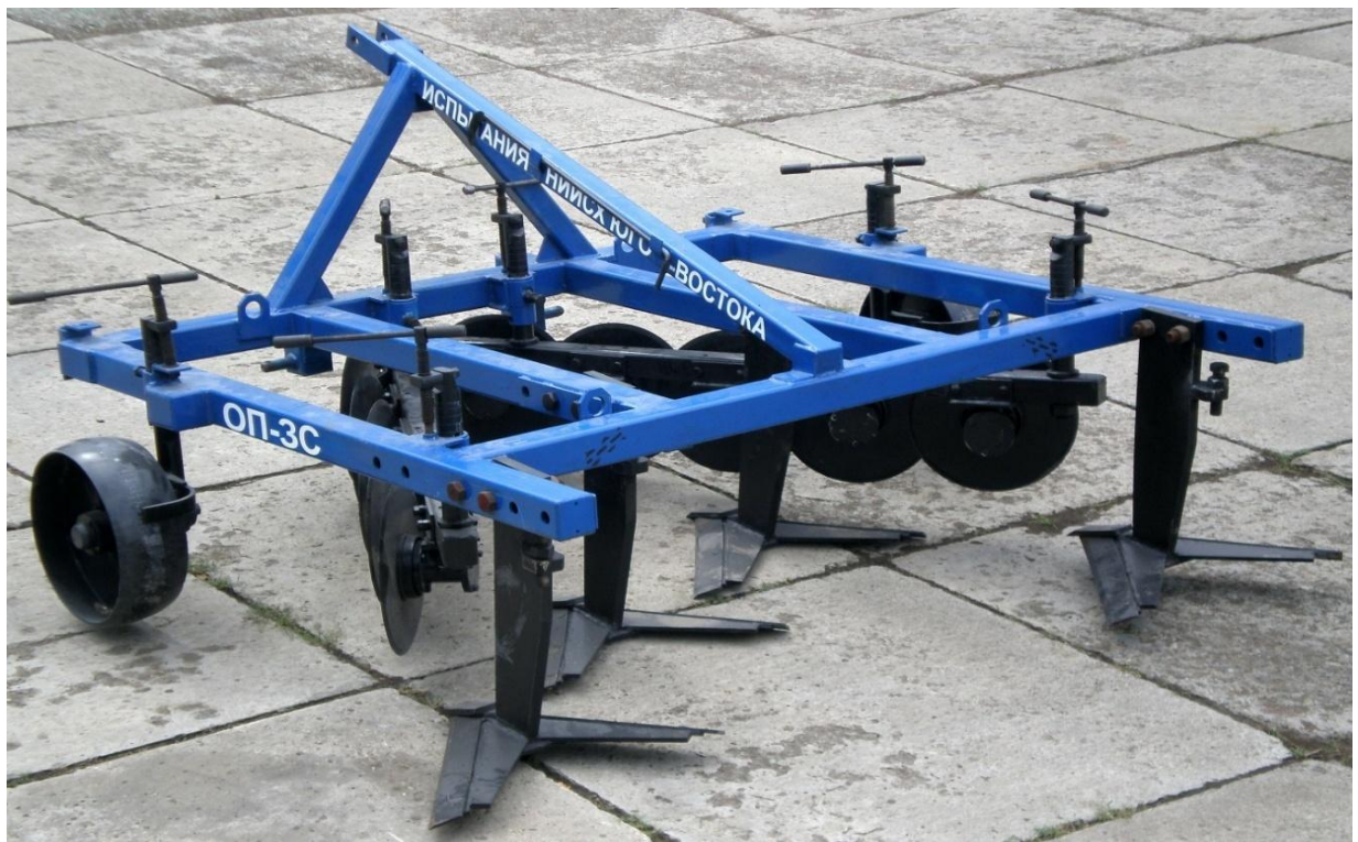
Рисунок 1.13 – Общий вид орудия для мелкой гребне-кулисной обработки почвы на склонах к трактору тягового класса 30...40 кН
