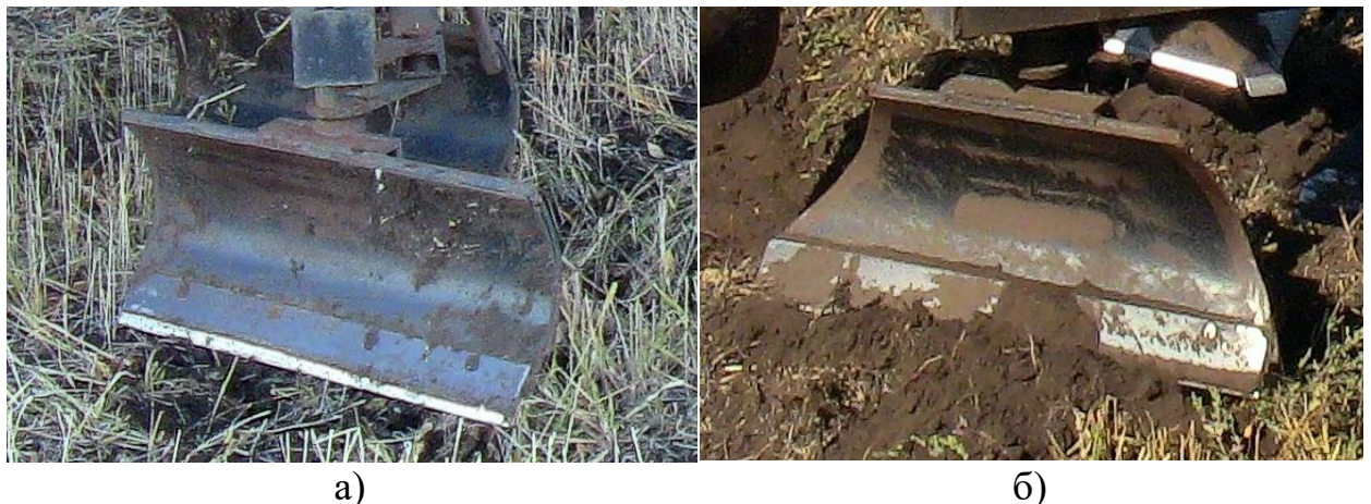
Рисунок 3.5 – Общий вид лемешного рабочего органа с отвальной поверхностью (а – отвальная поверхность с прямыми боковыми обрезами; б – отвальная поверхность со скошенными боковыми обрезами)
