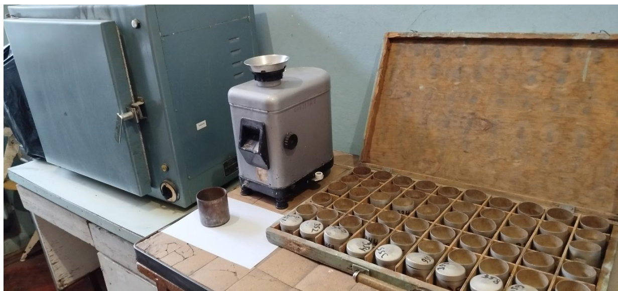
Рисунок 3.1 – Оборудование, используемое для определения плотности и влажности почвы (сушильный шкаф СЭШ-3М, весы ВЛКТ-500-М, металлический цилиндр и номерные бьюксы)
