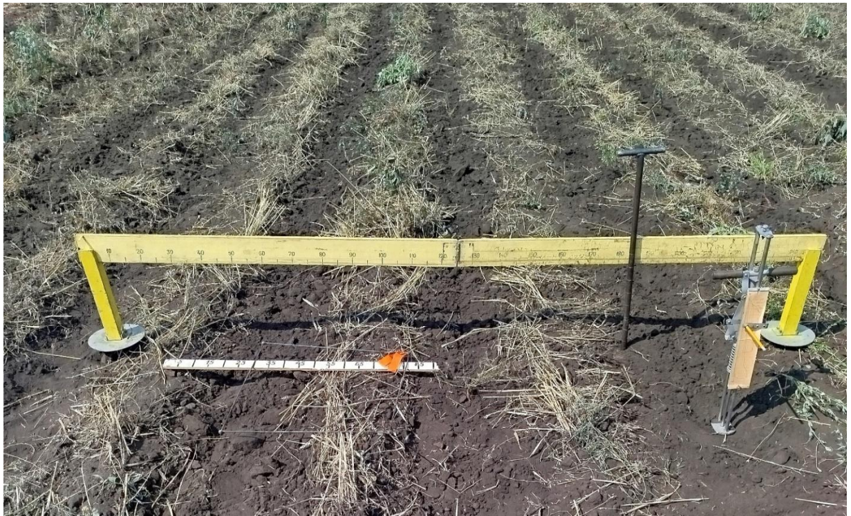
Рисунок 3.6 – Оборудование, используемое в лабораторно-полевых исследованиях (профильная линейка, твердомер Ревякина А. Н., агрономический щуп, рамка размером 0,5х0,5 м)
