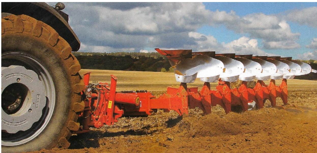
Рисунок 1.5 – Общий вид оборотного плуга для гладкой, отвальной обработки почвы к трактору 50 кН
