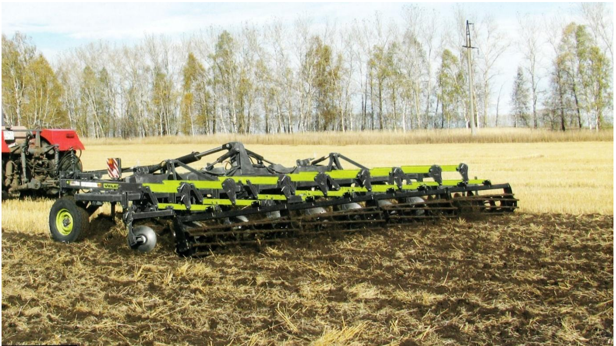
Рисунок 1.12 – Общий вид культиватора АН -8- КСО, для мелкой мульчирующей обработки почвы к тракторам тягового класса 50 кН
