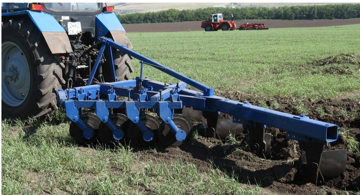
Рисунок 1.6 – Общий вид плуга ПЛН-5-35 с приспособлением для гребне-кулисной обработки почвы
