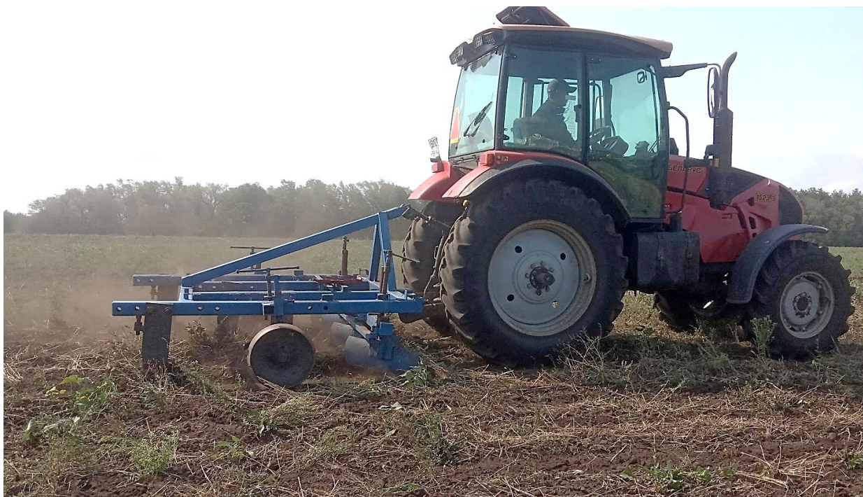
Рисунок 4.9 – Противозерозионное орудие в работе (агрофон – стерня озимой пшеницы)
